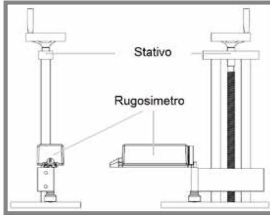
Lo stativo modello VLRGXST500 consente ai rugosimetri serie VLRGX di misurare, in modo stabile e preciso, campioni di differenti altezze.
