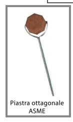
Piastra ottagonale conforme alle specifiche ASME-ASTM- MIL-AMS, utilizzata il controllo della magnetizzazione, per la ricerca della direzione del campo magnetico, per verificare la qualità delle polveri magnetiche a secco e ad umido.
